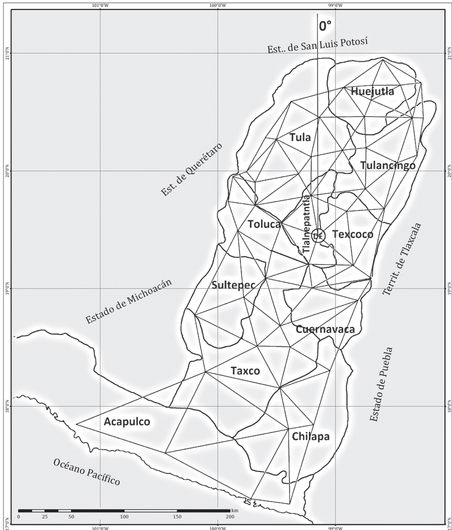
FIGURA 3. El Estado de México con la triangulación geodésica.
